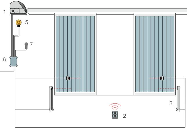
1. Sumo 2. Emetteur 3. Photocellules sur colonne 4. Photocellules 5. Lampe clignotante 6. Logique de commande 7. Sélecteur à clé ou à code.
